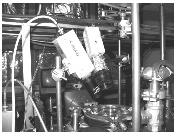
Rysunek 5.11: Kamery CCD wykorzystywane do badania obecności chmury zimnych atomów oraz kontrolowania położenia obszaru w którym powstaje fala zanikająca. Kamera widoczna w głębi zdjęcia dzięki zastosowaniu odpowiedniego obiektywu pozwalała na otrzymywanie obrazu z trzydziestokrotnym powiększeniem.
