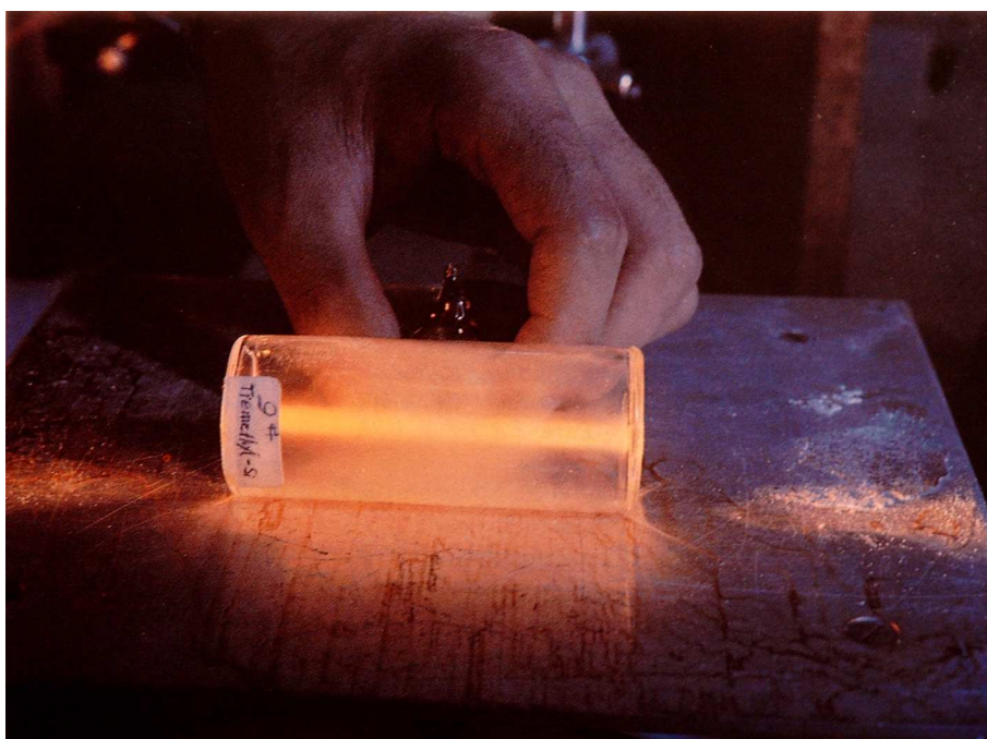
Rysunek 1.1: Fluorescencja atomów sodu obserwowana w temperaturze pokojowej, w komórce, w której ścianki zostały pokryte polydimethylsiloxanem.
